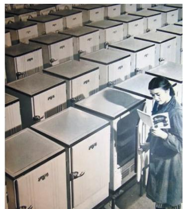
В 1950 г. на Московском заводе «Газоаппарат» был изготовлен первый серийный бытовой абсорбционный холодильник «Газоаппарат»
